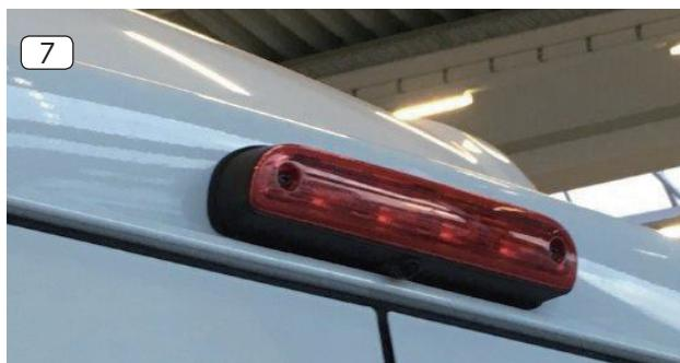
7. Den Bremslicht-Reflektor auf dem Hauptgehäuse der Kamera mit den Original-Kreuzschlitzschrauben rückmontieren
