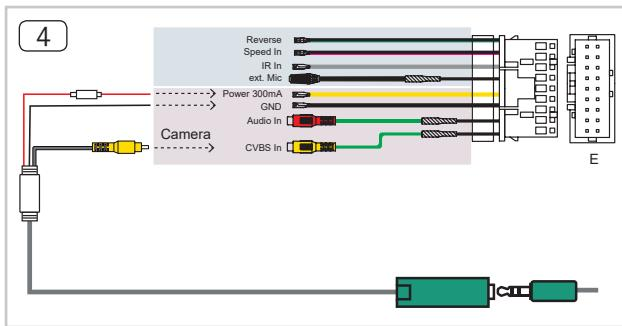
4. Hauptkabel vom Naviceiver im Armaturenbrett nach hinten zur Bremslichtöffnung einziehen. Für den Strom und Video Direktanschluss am ZENEC Z-E3726 gibt es den „Anschlussblock E“ mit geschalteten 300mA Stromausgängen (man beachte die Installationsanleitung der ZENEC HU).
