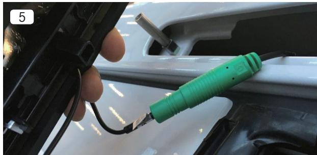
5. 3.5 mm Klinkenstecker Ausgang vom Kameratasensor an das grüne Gegenstück am Hauptkabel anstecken und mit Isolierband dicht umwickeln um das Eindringen von Wasser zu verhindern
