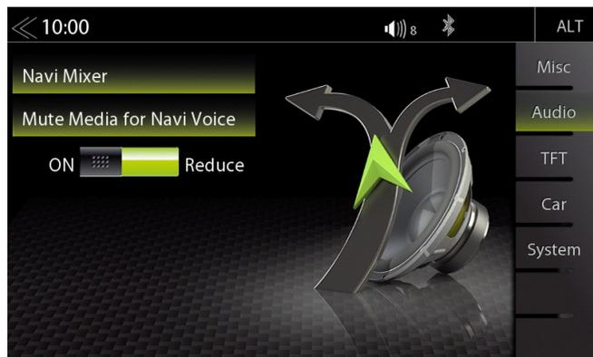
In questa pagina di menu modalità Esperto, è possibile regolare la funzione «ducking» audio o la disattivazione audio della riproduzione di sorgenti audio e video mediante guida vocale del percorso di navigazione. Funziona solamente con il nuovo pacchetto nav di ZENEC Z-EMAP50.
