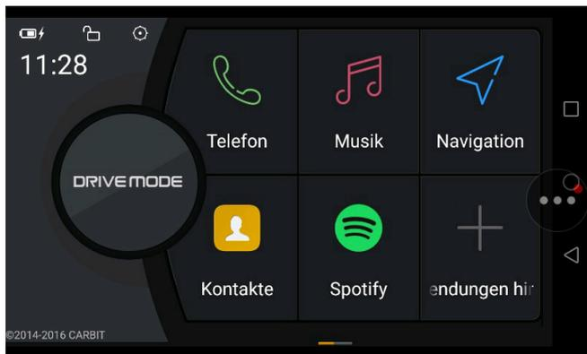
Sul pannello modalità Guida, si possono collegare App allo smartphone per creare una funzione incorporata Smartlink Direct sul dispositivo ZENEC. Toccare il campo della rispettiva funzione sul pannello modalità Guida a cui si desidera assegnare una funzione specifica. Con l'applicazione smartphone collegata, è possibile utilizzare le funzioni di controllo dell'applicazione direttamente tramite il dispositivo Zenec (Android OS).
