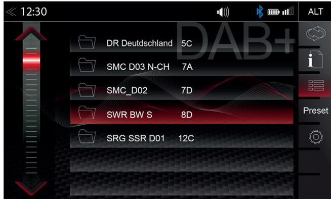
Quando la prima scansione della banda DAB+ è completata, il dispositivo mostrerà tutti gli Insiemi DAB+ e le stazioni radio con un'intensità di segnale sufficiente. La lista Insieme e il suo contenuto sono aggiornate automaticamente a intervalli regolari (mediante nuova scansione).
