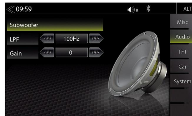
Dans le menu Mode Expert, vous pouvez modifier la valeur du gain, et le correcteur de basse (filtre pass-bas) du caisson de basses. Les réglages par défaut sont : Gain 0, LPF 100 Hz.
