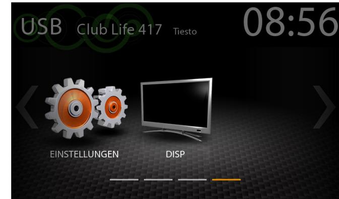
Mit dem Display Icon kann der LCD-TFT Bildschirm bei der Bildhelligkeit in zwei Stufen dunkler, bzw. ganz ausgeschaltet (Standby) werden. Dies erfolgt durch Antippen des Icons.
