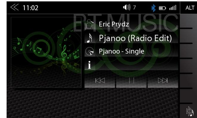
Die A2DP RVC Anbindung erlaubt die Play, Pause und Skip Kontrolle von gepairten mobilen Endgeräten, welche sich im Audio Playback Modus befinden. Die Anzeige von iD3-Tag Metadaten ist nur möglich, wenn diese auf den vom Smartphone gestreamten Titeln vorhanden sind.
