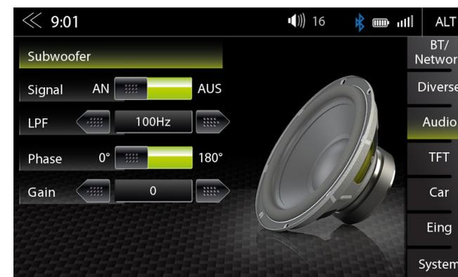
In diesem Expert Modus Menü können Sie die Phase, den Gain und die Tiefpass Übergangsfrequenz des Subwoofers einstellen. Die default Einstellungen sind Phase 0°, Power OFF, LPF OFF.
