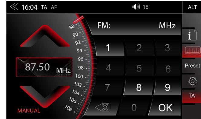
Wenn Sie die Senderfrequenzanzeige antippen, öffnet sich die numerische Eingabetastatur für eine direkte Senderfrequenz Eingabe.
