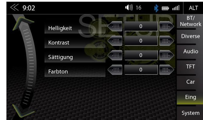
Im Inputs Setup Menü können Sie auf die Bildwiedergabe Parameter von angeschlossenen Video Quellen wie z.B. Rückfahrkameras Einfluss nehmen. Kontrast, Helligkeit, Farbsättigung und Farbton können angepasst werden.
