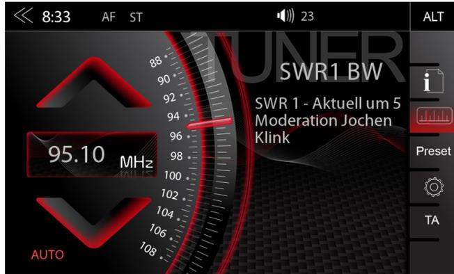
Im UKW Setup (Zahnrad Icon) kann den Senderfrequenz-Pfeilen eine manuelle (100kHz Schritte), oder auto Scan Funktion (bis zum nächsten Sender) zugewiesen werden. Siehe S.18.
