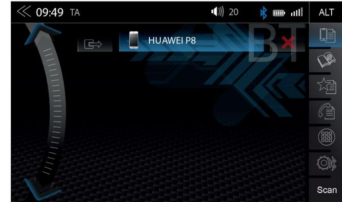
Damit ein Smartphone via Bluetooth mit dem Gerät verbunden werden kann, muss es einmalig gepairt werden.
