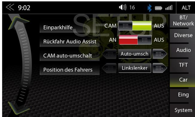
Im Car Setup Menü können Sie einstellen, wie das ZENEC Gerät auf im Fahrzeug vorhandene optionale Komponenten wie Kameras und Einparkhilfe interagiert. Zusätzlich kann eingestellt werden, ob das Fahrzeug ein Rechts- oder Linkslenker ist.
