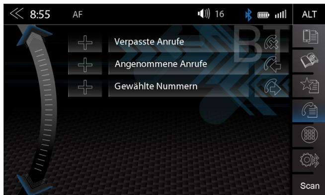
Ist ein kompatibles Mobiltelefon gekoppelt, werden die Anruflisten aus dem Mobiltelefon mit der Freisprecheinrichtung synchronisiert (dieser Vorgang kann je nach Anzahl der Kontakte einige Minuten dauern). Ist die Synchronisierung erfolgreich abgeschlossen, haben Sie Zugriff auf:
