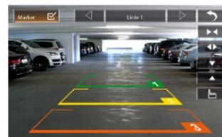
Rückfahrkamera Anbindung mit optionalen Distanzhilfslinien
