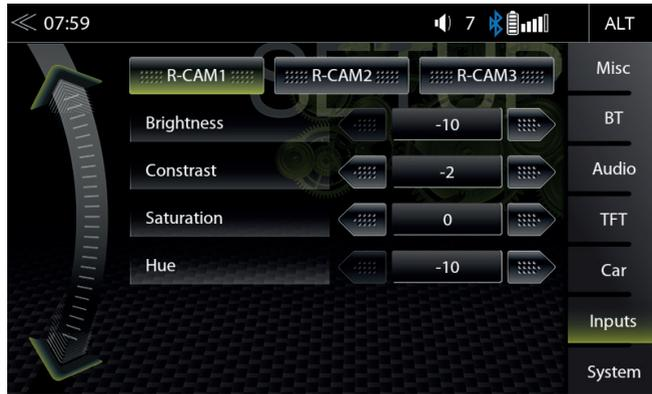
In questo menu di Configurazione Ingressi è possibile regolare le impostazioni dell'immagine di ciascun canale telecamera collegato, come ad es. le telecamere per la retromarcia. Si possono regolare il contrasto, la luminosità, la saturazione del colore e la tonalità.
