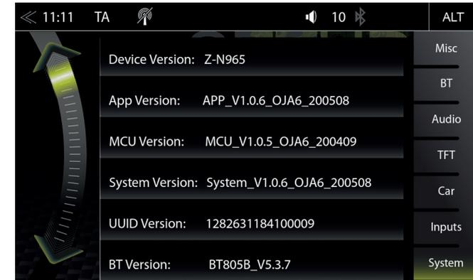
Nella pagina del menu Configurazione del sistema sotto la versione SW, verranno visualizzate le versioni software attualmente installate con informazioni dettagliate sulla versione per MCU, OS e APP ecc., compresa una semplice versione sintetica del software.
