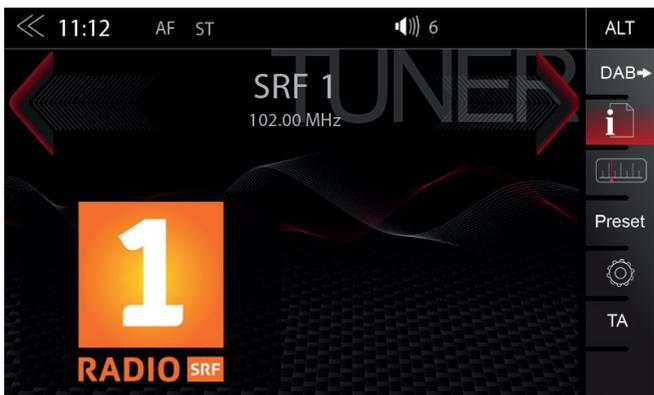
Il menu sorgente FM con RDS offre una sezione di controllo/operazione sulla destra, per modifiche rapide e comode durante la riproduzione della radio FM.
