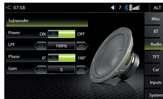
In questo menu modalità Esperto, è possibile regolare Fase, Guadagno e frequenze di transizione Low-pass del subwoofer. Le impostazioni di fabbrica sono Fase 0°, Alimentazione ON, LPF 100 Hz.
