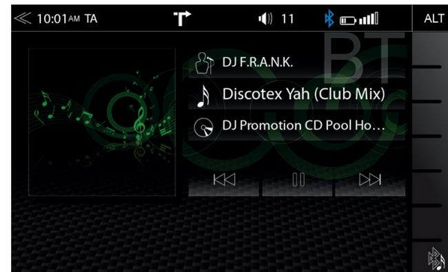
L'interfaccia A2DP RVC offre i controlli Riproduzione, Pausa e Salta di smartphone abbinati in precedenza in modalità riproduzione audio. Il display metadati Tag iD3-Tag è possibile solo quando i dati tag sono contenuti nel brano musicale trasmesso.
