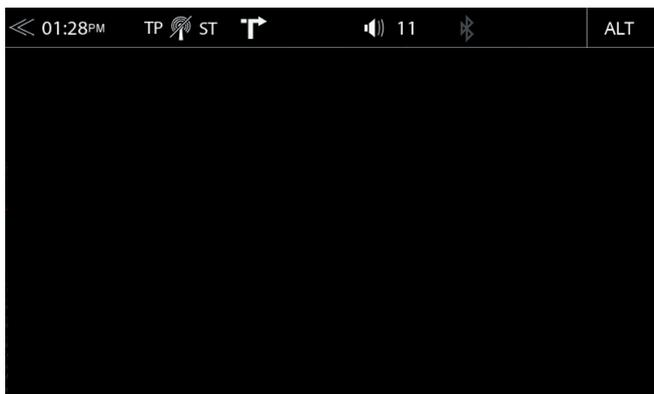
La “barra delle informazioni” nella parte superiore dello schermo mostra Servizio Infotraffico TA, volume e ora, ma contiene inoltre due importanti controlli per l’operazione del dispositivo: INDIETRO (sulla sinistra) e ALT (sulla destra).
