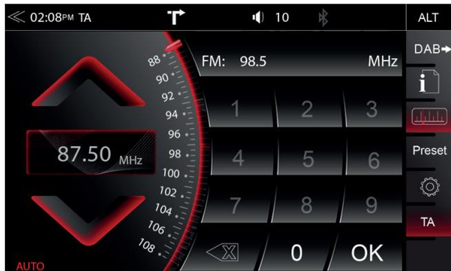
Quando si tocca sulla zona che visualizza la frequenza, si apre il tastierino numerico per inserire direttamente la frequenza di una stazione.
