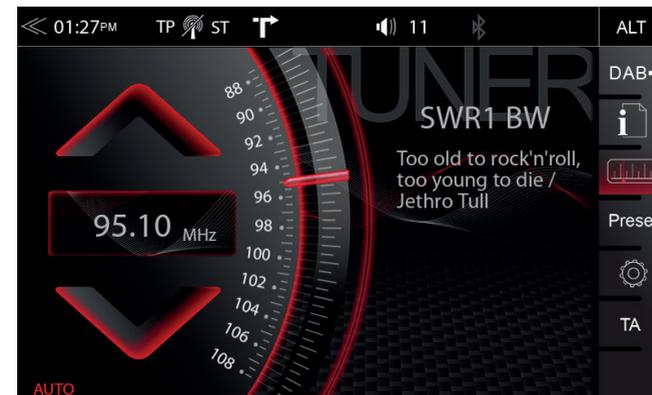
La modalità di configurazione FM (premere l'icona ingranaggio) consente di assegnare due diverse modalità di funzionamento ad entrambe le frecce di frequenza delle stazioni: avanzamento manuale di 100kHz, oppure scansione automatica (si ferma alla stazione successiva). Vedere pag.18.
